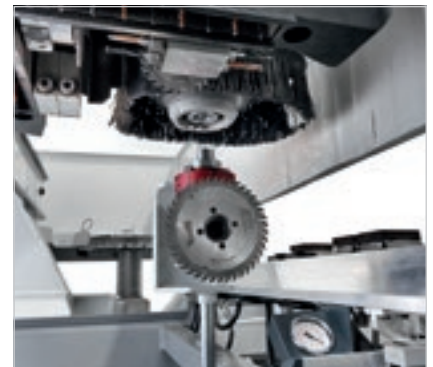
“抓取”工作站自动刀具库的作业。
