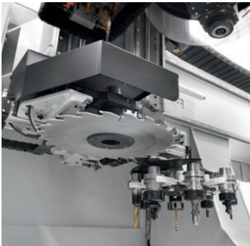
单刀位刀库和有 6 个刀位的转盘刀库。
